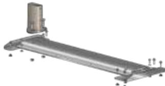
Placa de montaje para barandilla en chapas metálicas con paso de 250 mm perpendicular a la chapa
