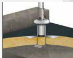
**Poste D con rotura del puente térmico**
