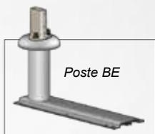
La barandilla VECTACO® VBE se fija en una cubierta de chapas con sistema impermeabilizante (cubierta de chapa con aislamiento). Este equipamiento está conforme al DTU 43.1. Está fijado al poste (Poste VBE) con tornillos taladradores DRILLNOX DBS2 que permiten una instalación rápida y fácil.
